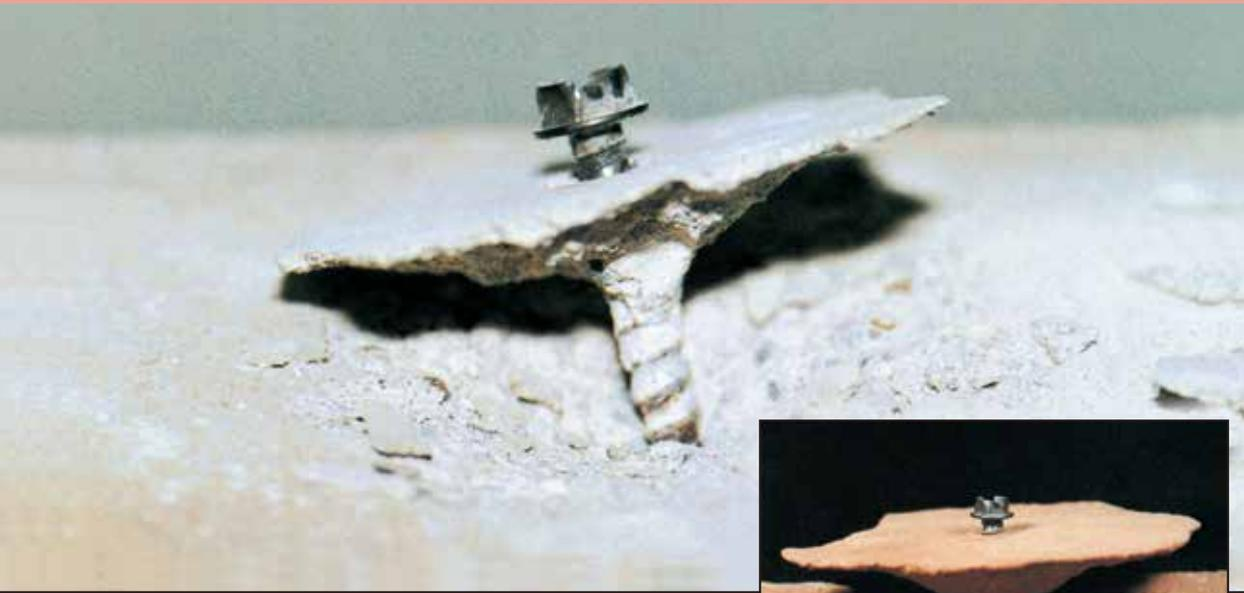
ファミコンをコンクリートに打込み引抜きテスト後の写真
